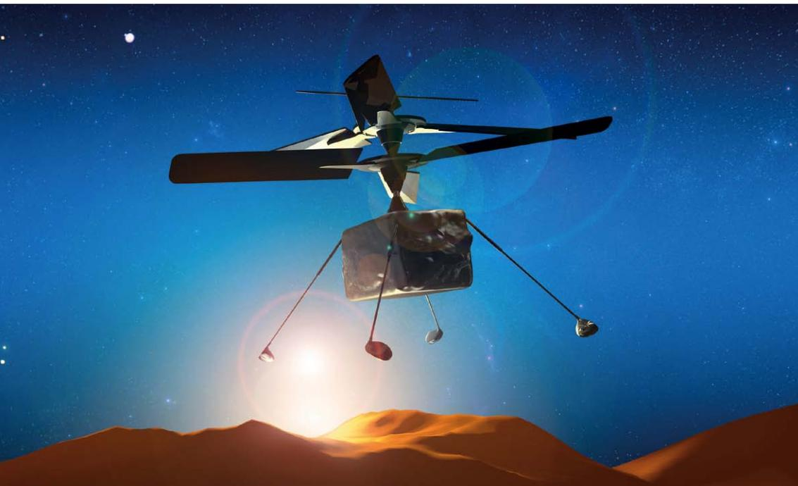
**A**ls Ingenuity auf dem Mars abhob, war er fast 300 Millionen Kilometer von der Erde entfernt; die Hin- und Rückübertragung eines Funksignals benötigte über 32 Minuten. Während seines Fluges verbrauchte der Hubschrauber rund 350 Watt. Die Lithium-Ionen-Batterien für den Antrieb seiner Zwillingsrotoren wurden durch Solarenergie aufgeladen.
