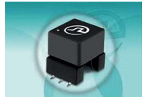
Bild 5: Push-Pull-Transformator mit verstärkter Isolierung für getrennte Stromversorgungs-Treiber, 8 mm Kriechstrecke, 5 kV RMS Isolierung (1000 V RMS kontinuierlich)
