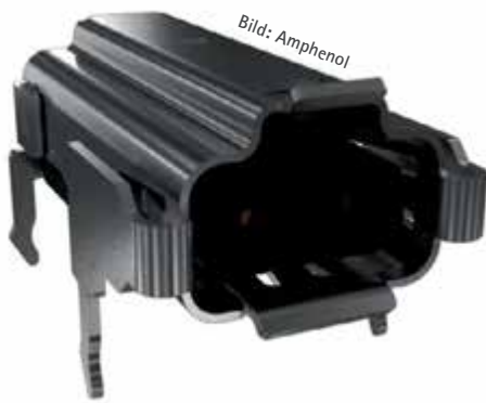
Bild 2: Die Standard-Single-Pair-Ethernet-Buchse von Amphenol mit Edge-to-Cloud-Konnektivität mit 50 W Power over Data-Line
