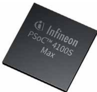
Bild 2: Mikrocontroller PSoC 4100S Max zur Datenauswertung
