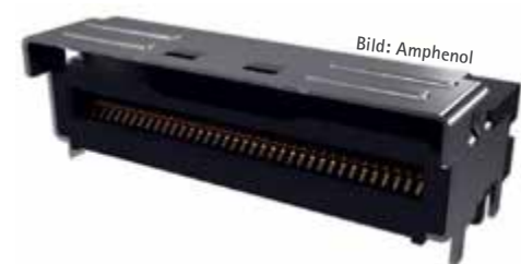
Bild 4: Der langlebige MCIO-Steckverbinder (Mini Cool Edge IO) von Amphenol kann Hochgeschwindigkeitssignale von bis zu 64 Gbit/s über eine Strecke von 1 m übertragen und erfüllt die neuen PCIe-Gen6-Anforderungen.
