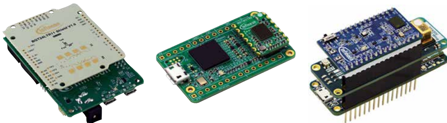
Bild 3: Entwicklungskits ergänzen die Radare: 24-GHz-Demo Distance2goL (links), Demo BGT60TR13C MMIC (Mitte) und 60-GHz-Connected-Sensor-Kit (rechts)
