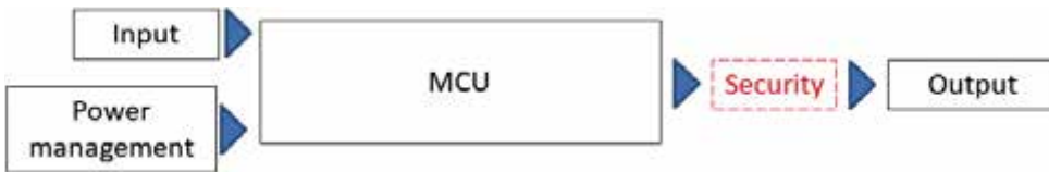
Bild 2: Stark vereinfachter Aufbau eines IoT-Geräts mit zusätzlicher Security-Hardware
