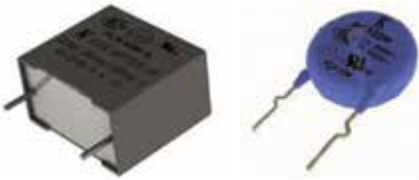
Bild 2: X-Y-Kondensatoren tragen meist ein oder mehrere Prüfzeichen.
