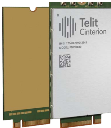
Bild 3: Mit bis zu 4,9 Gbit/s im Downlink, RTK-fähigem GNSS und OpenWRT-Unterstützung ist das FN990B40 auf anspruchsvolle Echtzeitanwendungen in der Präzisionslandwirtschaft ausgelegt.
