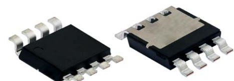
Bild 4: Vishays MOSFET mit Oberseitenkühlung, PowerPAK 8x8LR.
