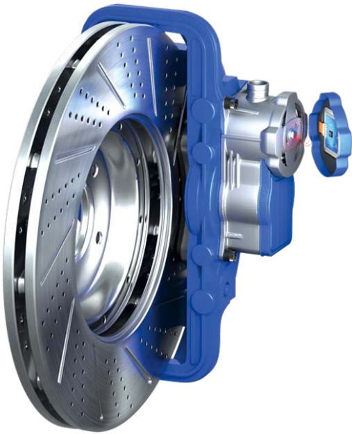
Bild 2: Bremsscheibe mit Bremssattel und Elektromotor. Der elektromechanische Bremsmechanismus (EMB) nutzt die Drehbewegung des Motors, um den Bremssattel zu bewegen und Kraft auf die Bremsscheibe auszuüben. Der Micronas HAL 3021 misst dabei präzise die absolute Position des Aktuators in einer End-of-Shaft-Konfiguration.
