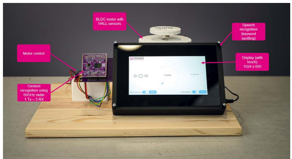
Bild 1: Gesamtansicht des Demonstrators mit Display, Radarmodul, Mikrocontroller-Board, Display und Motor. (Bilder: Rutronik System Solutions)
