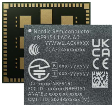
Bild 3: Moderne IoT-Module wie der nRF9151 unterstützen sowohl terrestrische als auch satellitengestützte Kommunikation.
