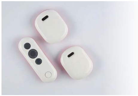
Bild 1: Das gaitQ Tempo (links) nutzt die Bluetooth LE-Funktionen des nRF5340 (rechts) SoC von Nordic, um die Fernbedienung und die am Bein getragenen Geräte für manuelle Vibrationssignale zu verbinden. (Bild: Nordic Semiconductor)
