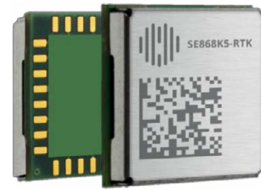
Bild 4: Das SE868K5-RTK-Modul verfügt über ein kompaktes Design mit integrierter RTK-Technologie für eine zentimetergenaue Positionsbestimmung mittels Dual-Frequenz-Empfang (L1/E1 und L5/E5). Es eignet sich somit für Anwendungen im Bereich Drohnen und Landwirtschaft.
