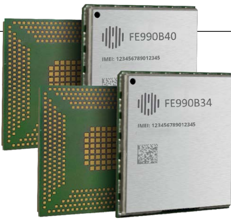
Bild 1: Das modulare LGA-Design der FE990-Serie ermöglicht lokale Datenverarbeitung und robuste 5G-Konnektivität direkt im Feld und ist damit für Umweltmonitoring, Stallautomatisierung und Gateway-Anwendungen geeignet. (Bilder: Telit Cinterion)
