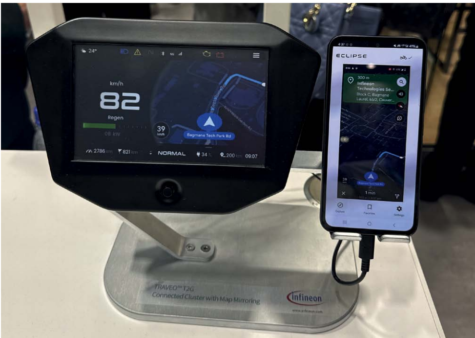
Bild 1: Eine mögliche Implementierung mit TRAVEO™ T2G Graphics zeigt auf der linken Seite die »Tachoanzeige« mit Geschwindigkeit und virtuellen Signal- bzw. Kontrollsymbolen sowie die von einem Smartphone eingeblendete Navigation. Rechts ist das Smartphone mit Funkverbindung zur Anzeigeeinheit zu sehen. (Bild: Infineon)
