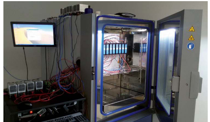
Bild 2: Typischer Testaufbau für einen Life-Test (z.B. 96-Stunden-Test bzw. Derating-Test)
