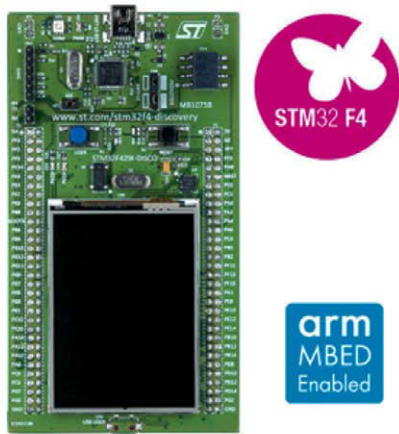
Bild 8: Der STM32 verfügt über ausreichend Speicher und Performance für die Verarbeitung von Sensorfusions-Daten und ermöglicht zum Beispiel, Predictive Maintenance als Embedded-Echtzeit-System zu realisieren.
