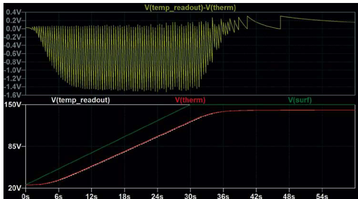
Bild 2: Die direkte transiente Schaltungssimulation zeigt das Temperaturprofil der Anwendung. Oben: externe Temperatur V(\text{surf}) , Temperatur des Thermistors V(\text{therm}) und digitalisierter Messwert ( T_{\text{on}} = 200 ms, n = 10 ). Im unteren Fenster: Differenz zwischen Messwert und tatsächlicher Temperatur des Thermistors
