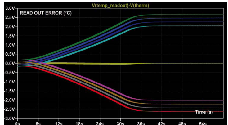
Bild 7: Temperatur-Messunsicherheit bei dR25 = 0,5\% für den NTC (aber mit dB = \pm 1,5\% ) und einer Festwiderstandstoleranz von \pm 0,25\%
