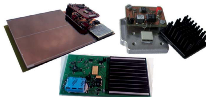
Bild 2: Energiewandler für Solar- und thermische Energie, realisiert am Lehrstuhl für Mess- und Sensortechnik der TU Chemnitz. Die Abwärme von Anlagen, umgewandelt mithilfe des Seebeck-Effekts, lässt sich gezielt nutzen, um Elektronik zu betreiben. Solarzellen dienen nicht nur in der Sonne der Energiebereitstellung, sondern können auch bei künstlicher Beleuchtung arbeiten. Eine genaue Anpassung zwischen Zelle und Lichtquelle ermöglicht eine hohe Ausbeute. Speziell in Produktionsumgebungen ermöglicht die konstante Beleuchtung eine zuverlässige Versorgung von Sensornetzen.
