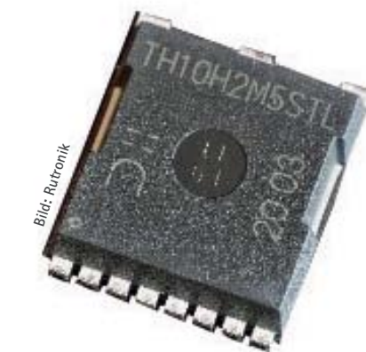
Bild 2: MOSFET von Diodes in Gehäuse PowerDi1012 (TO Leadless)
