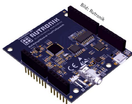
Eine schnelle Realisierung hochqualitativer Sprachausgaben ermöglicht das Arduino-kompatible Adapter-Board von Rutronik.
