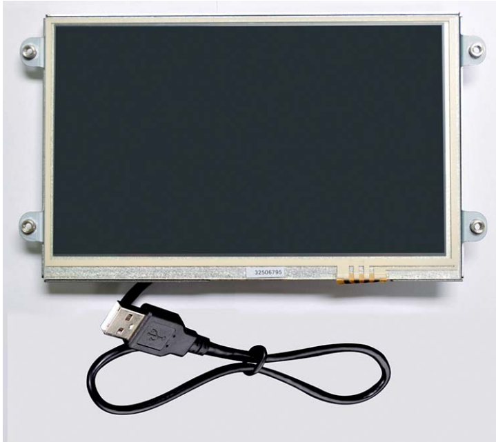
Ein Kabel genügt für die Videosignal- und Strom- sowie zur Touch-Übertragung.
