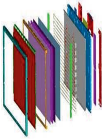
Aufbau Standard Konsumer (TV) Monitor
