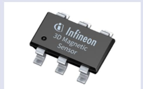
Der 3D-Magnetsensor TLV493D-A1B6 von **Infineon** bietet eine präzise dreidimensionale Erfassung bei äußerst geringer Leistungsaufnahme. Mit seinem kleinen 6-poligen Gehäuse ermöglicht der Sensor die direkte Messung von Magnetfeldkomponenten in x-, y- und z-Richtung, wodurch er ideal geeignet ist für die Messung von 3D-Bewegungen, linearen Bewegungen und Drehungen um 360°. Durch die Unterbringung der 3-Achsen-Messung in einem kleinen Gehäuse und die geringe Leis-
