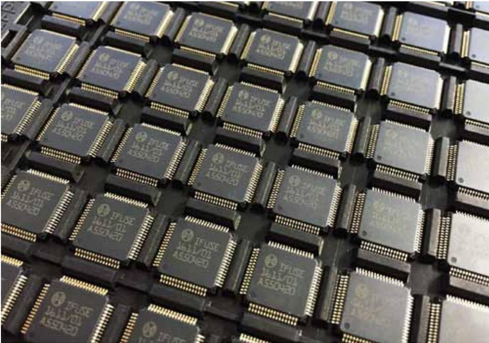
Die Strommessung kommt mit dem iFuse ohne externe Sensoren wie Shunt-Widerstände aus. Quelle: Bosch
