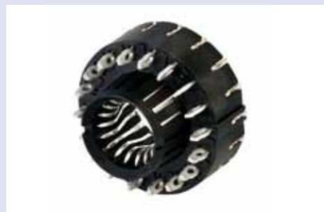
„SheerPwr Circular“ von **Amphenol FCI** ist ein niederohmiges Hochstrom-Steckverbindersystem für den Anschluss von Sammelschienen auf Leiterplatten. Diese Schnittstelle verwendet einen robusten Stromkontakt, der in einer kreisförmigen Ausrichtung montiert ist. Das Ergebnis ist eine Power-Buchse, die sich mit maschinell bearbeiteten Stiften verbinden lässt. Sie bietet einen wiederholt niedrigen Widerstand, eine hohe Fehlausrichtung und eine gute Stromführung. D.h. auch wenn die Stifte
