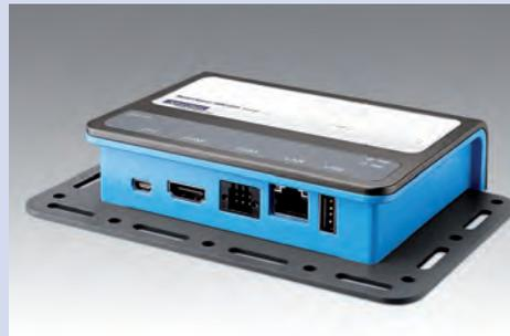
Der handtellergroße UBC-220 von **Advantech** kommt mit einem Freescale ARM® Cortex™-A9 i.MX6 Dual Lite-Prozessor mit 1GHz, 1GB On-board-Speicher und 4GB eMMC-Flashspeicher. Dank Dual-Display-Unterstützung für Full HD
