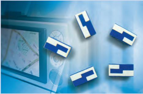
Mit Abmessungen von nur 3,2x1,6mm ist die neue Chipantenne ANT3216LL00R2400A von Yageo optimal für IoT-Anwendungen, die einen kleinen Formfaktor erfordern. Die Antenne hat eine Bandbreite von 160MHz und eine maximale Verstärkung von 5,05dBi. Sie arbeitet mit ungerichteter Strahlung und linearer Polarisation bei einer Frequenz von 2,4GHz. Der Betriebstemperaturbereich liegt bei -40 bis +105°C, die Impedanz beträgt 50Ω bei einer maximalen Leistung von 1W. Die Antenne ist
