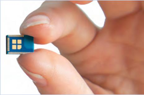
ten ARM Cortex M0-Mikrocontroller und arbeitet mit IDE von Arduino mit Simblee-Erweiterungen. Trotz seines Formfaktors von lediglich 7x10x2,2mm verfügt das Modul über eine integrierte Antenne sowie BLE, Mesh, Cloud und andere Formen der drahtlosen Konnektivität. Im extrem sparsamen Ruhemodus verbraucht der Simblee nur 600nA. Dank der neuen Simblee-Entwicklungsumgebung ist Xcode bzw. Android SDK für die Entwicklung von Apps für Mobiltelefone nicht erforderlich.
