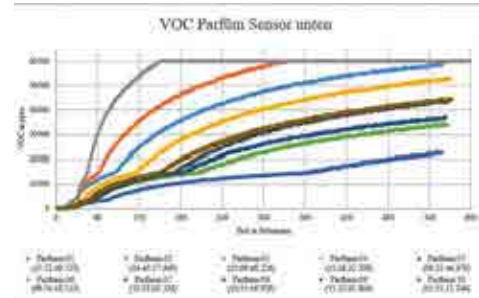
Bild 2: Die VOCs von Parfüm zeigen bei zehn Messungen in der kleinen Kammer der Versuchsanordnung ein unterschiedliches Verhalten.
