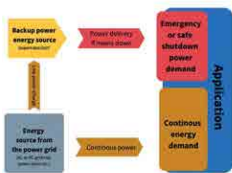
Bild 3: In Fehlerfällen der Energiequelle (z.B. des Stromnetzes) können Supercaps als Backup-Speicher Energie liefern, z.B. um Server sicher herunterzufahren.
