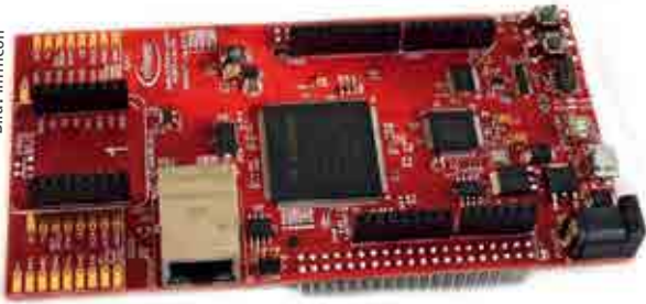
Bild 1: Das TC375 Lite Kit von Infineon lässt sich mit vielen Entwicklungswerkzeugen für Motorsteuerungen und Sicherheitsanwendungen nutzen.
